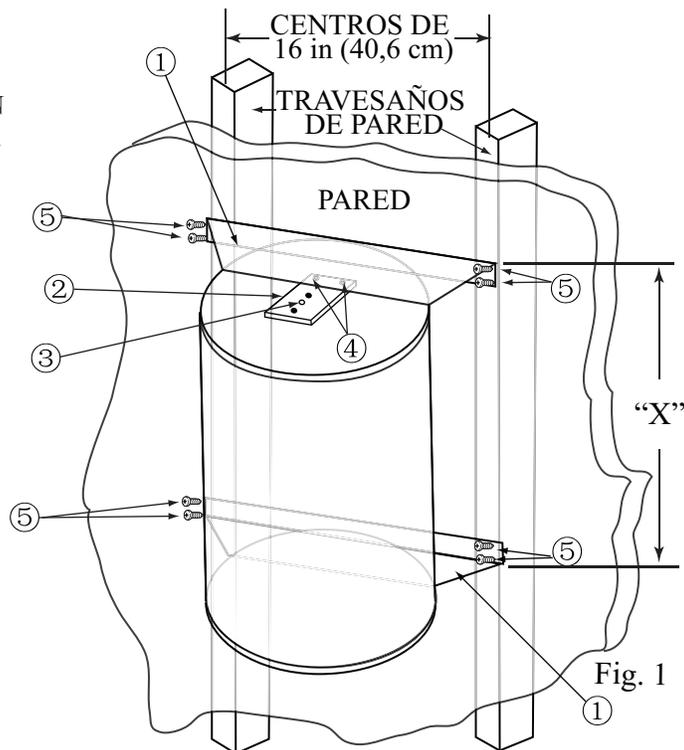
1. Ubique los travesaños de pared en el área donde se montará el calentador de agua. Los soportes de pared están diseñados para travesaños ubicados a una distancia a centros de 16 in (40,64 cm). Consulte la figura 1.
