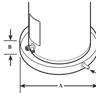
Para abrir el desagüe, la tubería debe tener por lo menos 3/4 in (1,9 cm) de diámetro interno y estar montada para un desagüe adecuado.
