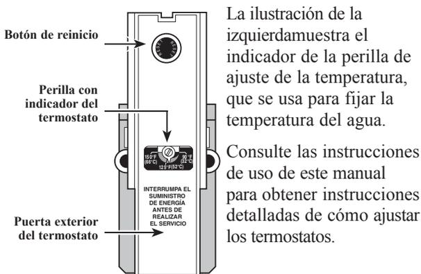
La ilustración de la izquierdamuestra el indicador de la perilla de ajuste de la temperatura, que se usa para fijar la temperatura del agua.
