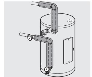
Instalación típica de tubería lateral
