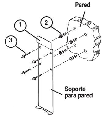
Figura 3: Montaje del soporte para pared.
