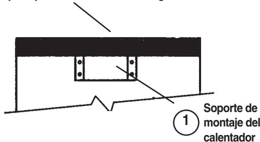
Figura 1: Ubicación del soporte del calentador en el calentador de agua.
