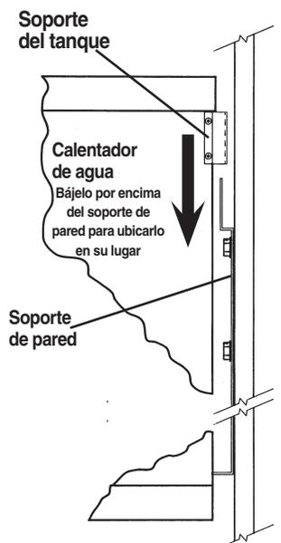
Figura 4: Colocación del calentador de agua en el soporte para pared.
