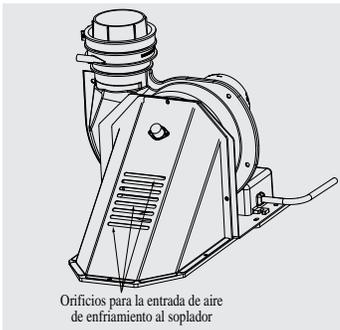
Ubicación de los orificios para la entrada de aire de enfriamiento al soplador
