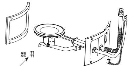
El ensamblaje incluye abrazaderas Speed Clips™ y tornillos de seguridad adicionales.
