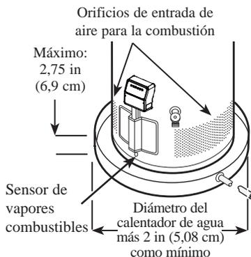
La instalación de la bandeja colectora auxiliar **DEBE** cumplir con los códigos locales.
