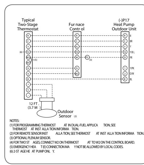
TYPICAL TWO-STAGE THERMOSTAT: (-)P17 HEAT PUMP WITH ELECTRIC HEAT USING A HUMIDISTAT FOR DEHUMIDIFICATION
