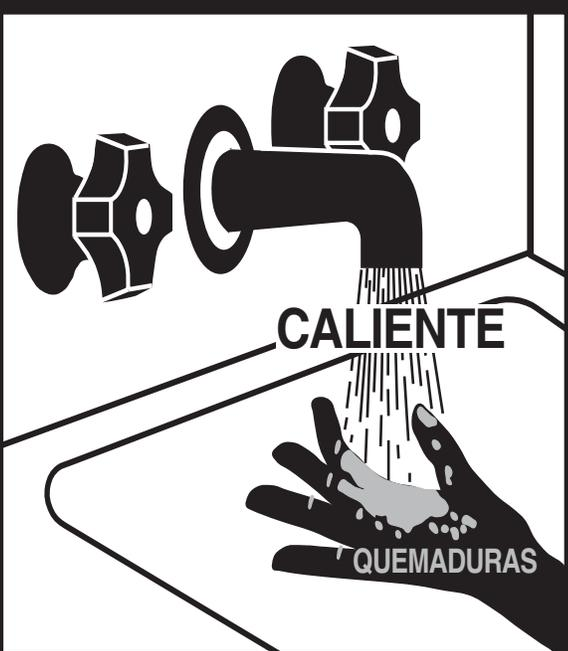
El agua a temperaturas superiores a 125 °F (51,6 °C) puede ocasionar quemaduras graves al instante o la muerte por escaldaduras.
