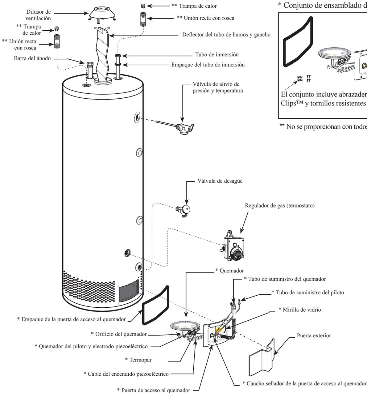
\* Conjunto de ensamblado del quemador
