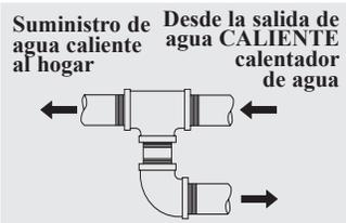
Conector en forma de T para tuberías horizontales de suministro de agua caliente
