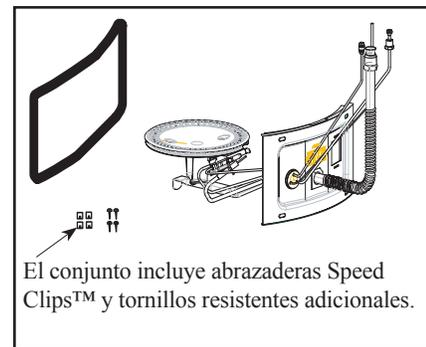
El conjunto incluye abrazaderas Speed Clips™ y tornillos resistentes adicionales.
