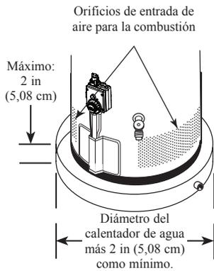
La instalación de la bandeja colectora auxiliar DEBE cumplir con los códigos locales.
