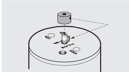
Instalación típica en la conexión superior
