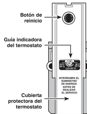
La ilustración de la izquierdamuestra el indicador de la perilla de ajuste de la temperatura, que se usa para fijar la temperatura del agua.
