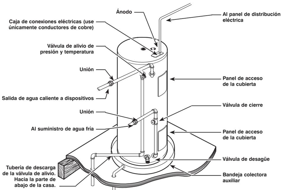
Se incluye una válvula de alivio de combinación de presión y temperatura nueva que cumple con las normas para válvulas de alivio y dispositivos de cierre automático de gas para sistemas de suministro de agua caliente, ANSI Z21.22, y debe permanecer instalada en la abertura provista y marcada para ese fin en el calentador de agua. No debe instalarse ninguna válvula entre la válvula de alivio y el tanque. Los códigos locales deben regir la instalación de las válvulas de alivio.
