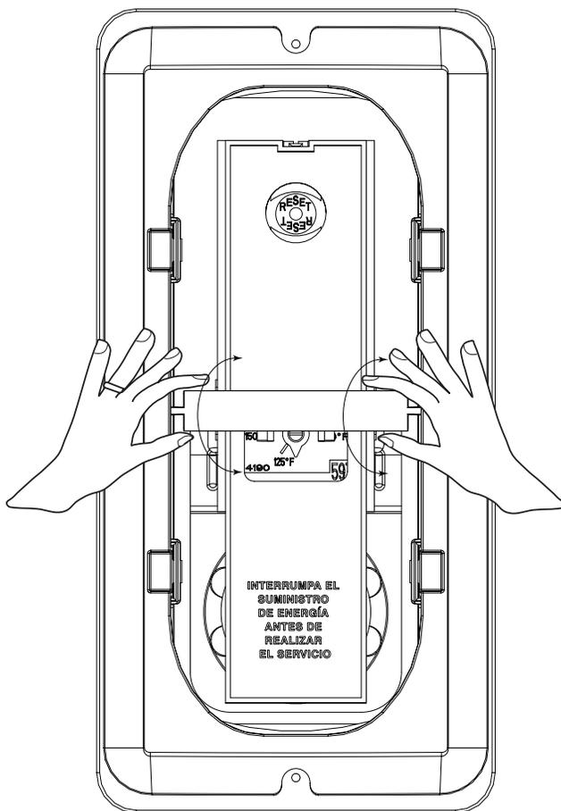
Para reemplazar el termostato o el elemento térmico, extraiga el travesaño de la cavidad siguiendo las instrucciones a continuación:
