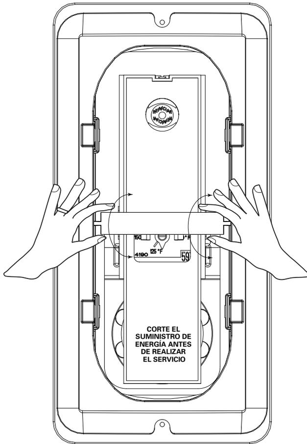
Para reemplazar el termostato o el elemento térmico, extraiga el travesaño del inserto de la cavidad siguiendo las instrucciones a continuación:
