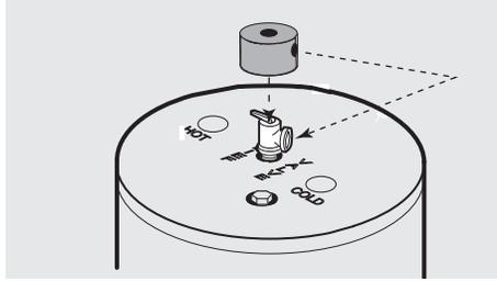
**Instalación típica de la conexión superior**
