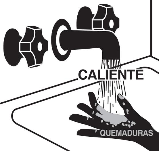
**El agua a temperaturas superiores a 125 °F (51,6 °C) puede ocasionar quemaduras graves al instante o la muerte por escaldaduras.**
