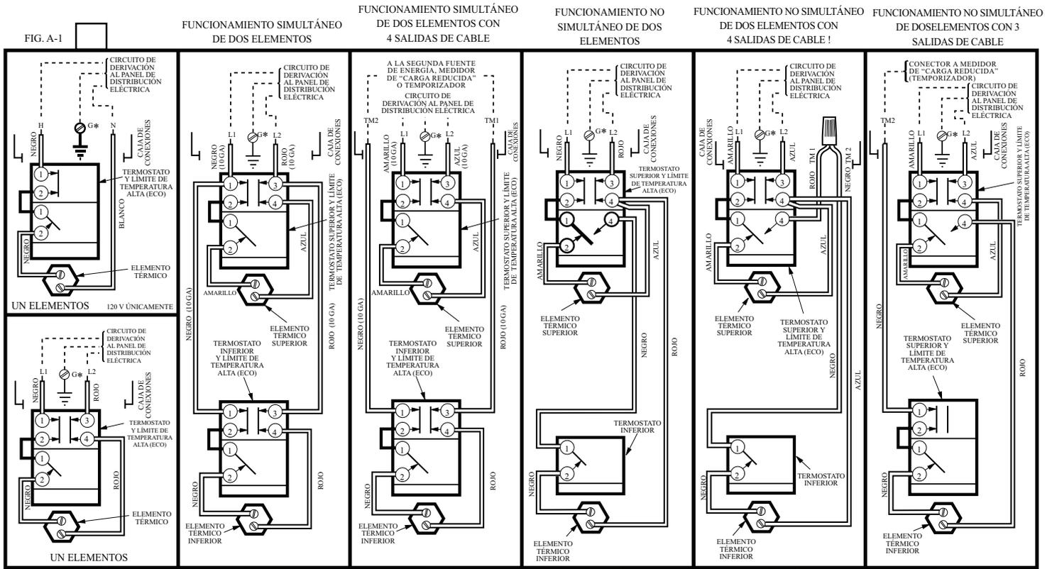
\* Es posible que requiera un conductor de conexión a tierra. Consulte la sección sobre cableado del manual.
