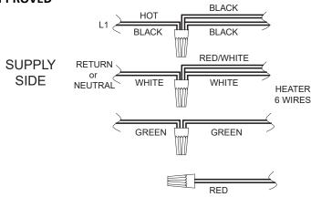
Figure 21. 120 VAC Wiring
