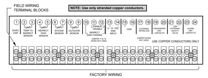
Figure 29. Low-Voltage Wiring
